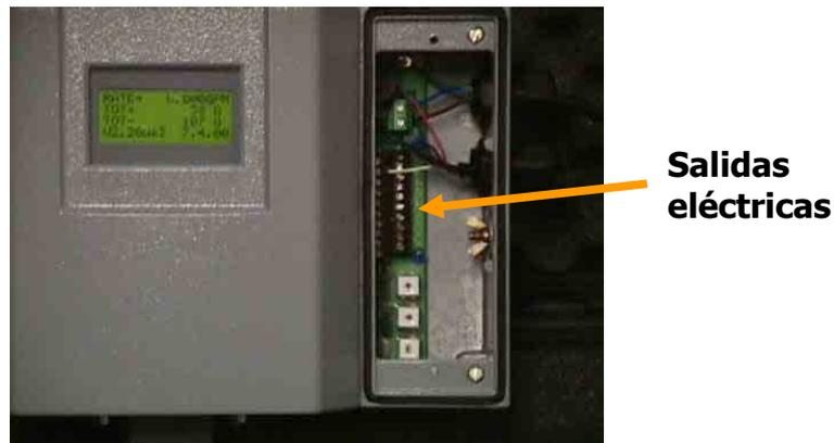
**Figura 11. Elemento secundario de un medidor de flujo Electromagnético.**
